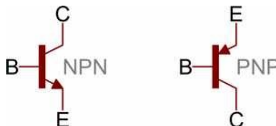
Τα σύμβολα κυκλώματος για τα τρανζίστορ NPN και PNP
